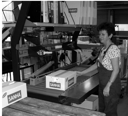
그림 10: 수직 조절식 작업 테이블과 롤러 컨테이너를 사용한 올리기 및 옮기기 활동의 해결
